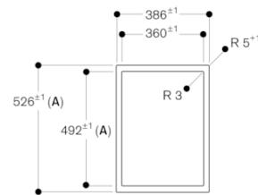
А: При монтаже с крышкой прибора учитывайте глубину выреза
